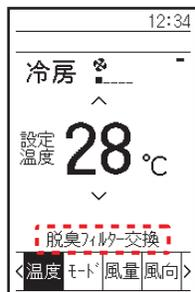
基本画面に「脱臭フィルター交換」が表示されたら、脱臭フィルターを交換し、サインのリセットを行ってください。交換方法は空気清浄ユニットの取扱説明書をご覧ください。
