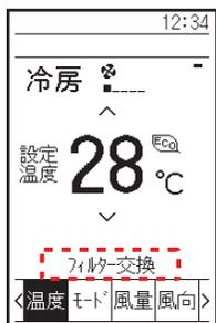
基本画面に「フィルター交換」が表示されたら、フィルターを交換し、サインのリセットを行ってください。交換方法は室内ユニットの取扱説明書をご覧ください。
