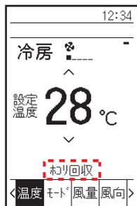
基本画面に「ホコリ回収」が表示されたら、ダストボックスのホコリを回収し、サインのリセットを行ってください。
